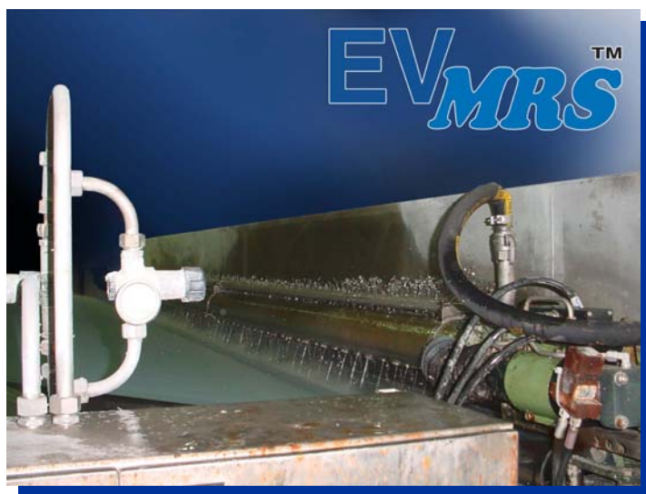
Sumuton yläviiran alue EV MRS™:n asentamisen jälkeen
